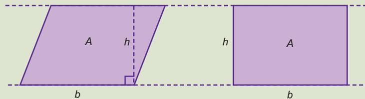
Le parallélogramme peut être transformé en rectangle. Par conséquent, si l'on connaît les dimensions de la base et de la hauteur d'un parallélogramme, on peut déterminer son aire en appliquant la même formule que celle que l'on utilise pour déterminer l'aire d'un rectangle.
