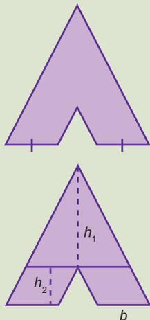
On peut d'abord décomposer la figure en 1 triangle et 2 parallélogrammes congruents. Si l'on connaît la base  $b$  de l'un des parallélogrammes ainsi que les hauteurs  $h_1$  et  $h_2$  indiquées, on peut déterminer l'aire de la figure plane dans la mesure où l'on reconnaît que la base du triangle est égale au double de la base  $b$ .
