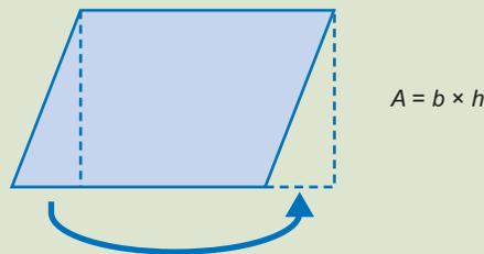
Il est à noter que la hauteur du parallélogramme est inférieure à la longueur de son côté incliné. Il est donc important d'utiliser les mesures de la base et de la hauteur d'un parallélogramme pour déterminer son aire, et non les mesures de ses côtés.
