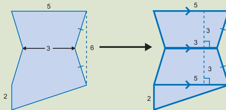
Chaque trapèze a une hauteur de 3 unités ( $6 \div 2$ ) et une aire de 12 unités carrées  $\left[\frac{1}{2}(3 + 5) \times 3\right]$ . Le triangle a une aire de 5 unités carrées  $\left[\frac{1}{2}(2 \times 5)\right]$ . Par conséquent, la figure composée a une aire de 29 unités carrées ( $12 + 12 + 5$ ).
